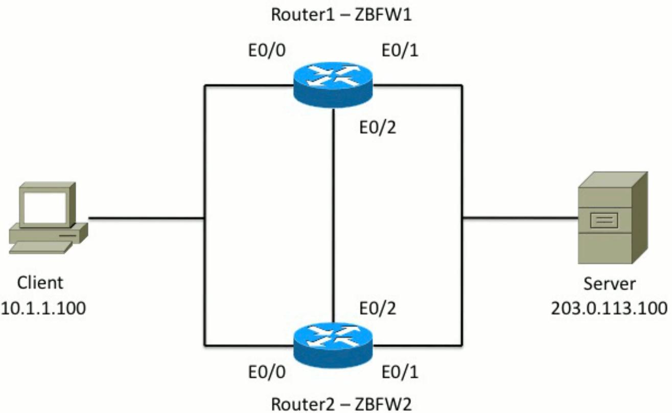
在範例1所示的組態中，設定ZBFW是為了檢查TCP、UDP和網際網路控制訊息通訊協定(ICMP)從內部到外部的流量。粗體顯示的配置設定HA功能。在Cisco IOS路由器中，HA是通過**redundancy subconfig**命令配置的。為了配置冗餘，第一步是在全域性檢查引數對映中啟用冗餘。
