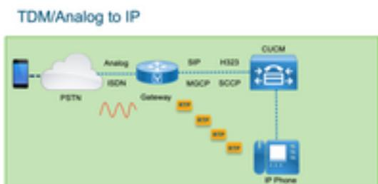
随着VoIP的引入，客户开始迅速将其传统系统转变为现代VoIP基础设施。在运营商端也发生了同样的情况，他们现在使用连接将本地电话服务与运营商VoIP基础设施互联，并扩展其功能以提供更好的服务。目前最常用的VoIP协议是会话发起协议(SIP)，目前被全球的客户和互联网电话服务提供商(ITSP)广泛使用。
