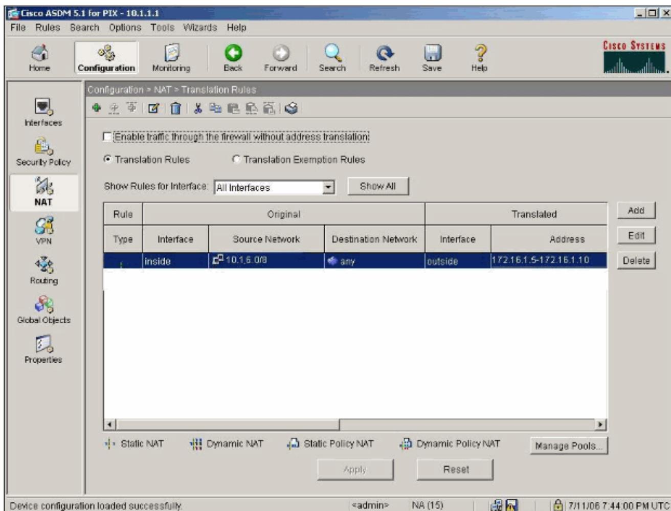
现在，内部的主机可以访问外部网络。当内部主机启动与外部的连接时，它们将被转换为全局池中的某个地址。全局池中的地址按照先到先得的原则分配，并且从池中的最小地址开始分配。例如，如果主机10.1.6.25是第一个发起到外部的连接，则它会收到地址172.16.1.5。下一台主机发出后会收到172.16.1.6，依此类推。这不是静态转换，在超时`xlate hh:mm:ss`命令定义的一段非活动时间后，**转换超时**。如果内部主机的数量多于池中地址的数量，则池中的最后一个地址将用于端口地址转换 (PAT)。
