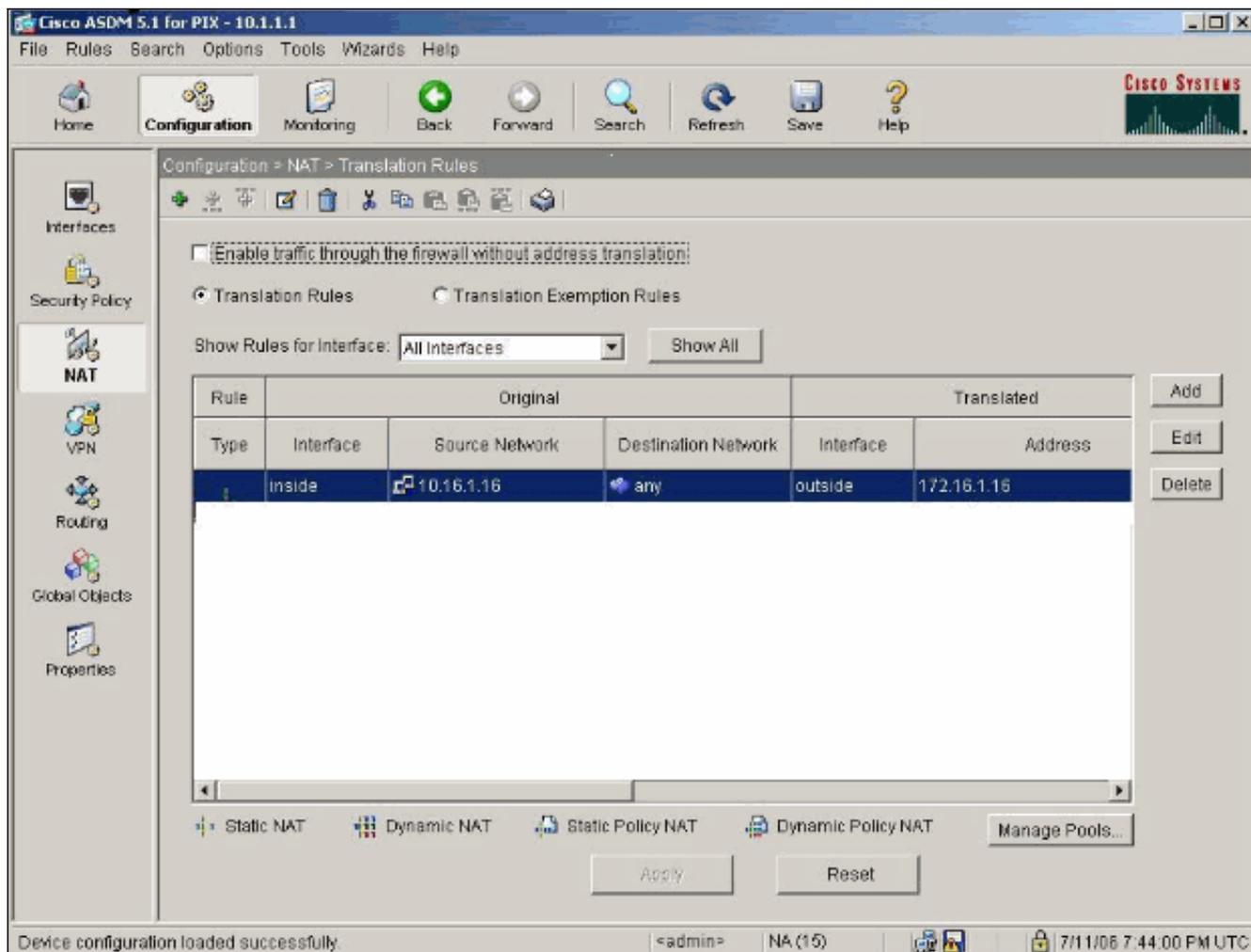
8. 请使用[限制内部主机对外部网络的访问过程以输入 access-list 条目](#)。注意：实施这些命令时要小心。如果执行 `access-list 101 permit ip any any` 命令，则只要存在活动转换，不受信任网络上的任何主机都可以使用 IP 访问受信任网络上的任何主机。
