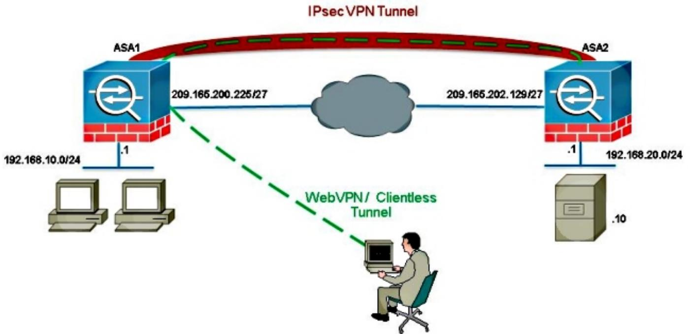
通常，ASA2对192.168.20.0/24执行端口地址转换(PAT)以提供互联网访问。在这种情况下，当ASA2上来自192.168.20.0/24的流量进入209.165.200.225时，应从PAT进程中排除。否则，响应不会通过LAN到LAN隧道。例如：
