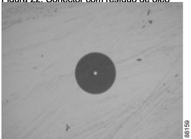
Figura 23: Conector com arranhões
