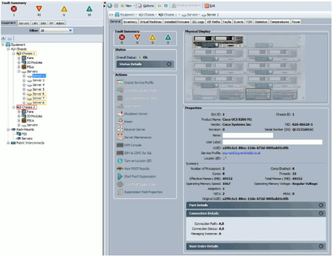
5. KVM IP 주소를 ping할 수 있지만 KVM에 연결할 수 없는 경우 네트워크에 중복 IP 주소가 있을 수 있습니다. 이를 확인하는 한 가지 방법은 블레이드에 사용되지 않는 새 IP 주소를 정적으로 할당하는 것입니다. 호스트를 제거할 수 있는 경우 문제의 블레이드를 해제한 다음 KVM IP 주소를 다시 ping해 보십시오. 그래도 성공하면 해당 IP가 네트워크에서 복제됩니다. 다른 디바이스에서 IP를 제거하거나 해당 주소를 포함하지 않도록 UCS MGMT IP 풀을 조정합니다.
