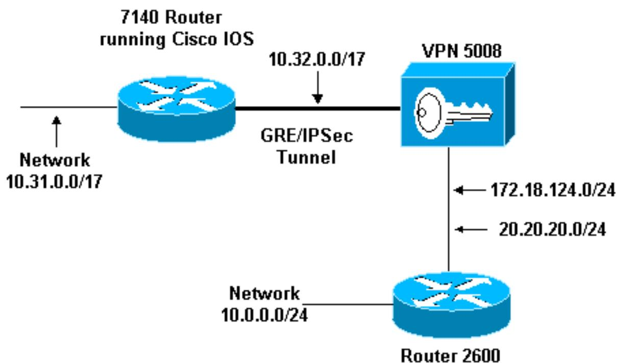
GRE over IPSec은 Cisco IOS 라우터(7140)와 Cisco VPN 5008 Concentrator 간에 구성됩니다. 이러한 디바이스 뒤에는 7140과 VPN 5008 사이의 GRE 터널 내에서 실행되는 RIP를 통해 여러 네트워크가 광고됩니다.
