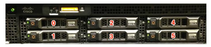
참고:표시된 X1070은 완전히 채워진 어플라이언스입니다.모든 어플라이언스 모델에 완전히 채워진 드라이브 베이 컨피그레이션이 있는 것은 아닙니다.사용하지 않는 베이에 드라이브 트레이가 삽입됩니다. 어플라이언스에서 사용하지 않으므로 이 베이에 하드 드라이브를 제거하거나 삽입하지 마십시오.
