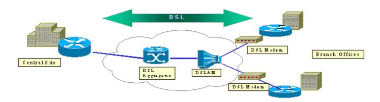
Cisco 2600 및 3600 라우터는 ADSL WAN 인터페이스 카드(WIC-1ADSL)를 지원합니다. 이 WIC-1ADSL은 지사의 요구 사항을 충족하도록 설계된 멀티 서비스 및 원격 액세스 솔루션입니다.WIC-1ADSL 및 하드웨어 암호화 모듈이 도입됨에 따라 단일 라우터 솔루션에서 지사에서 IPSec 및 DSL에 대한 수요가 늘어났습니다.WIC-1ADSL을 사용하면 별도의 DSL 모뎀이 필요하지 않습니다.하드웨어 암호화 모듈은 라우터에서 처리하는 암호화를 오프로드할 때 소프트웨어 전용 암호화에 비해 최대 10배의 성능을 제공합니다.
