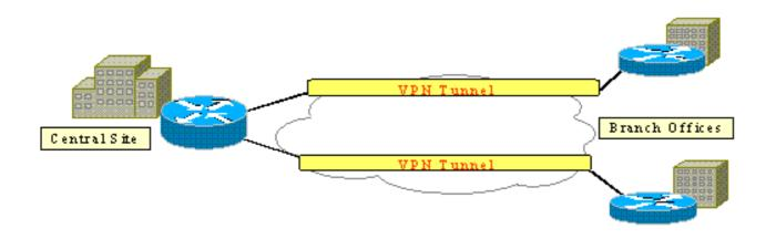
이 그림에는 일반적인 IPSec VPN이 나와 있습니다.지사와 중앙 사이트 간에는 수많은 원격 액세스 및 사이트 대 사이트 연결이 포함됩니다.일반적으로 사이트 간에 프레임 릴레이, ISDN, 모뎀 전화 접속 등의 기존 WAN 링크가 프로비저닝됩니다.이러한 연결에는 고가의 1회 프로비저닝 비용과 월비용이 들 수 있습니다.또한 ISDN 및 모뎀 사용자의 경우 연결 시간이 길어질 수 있습니다.
