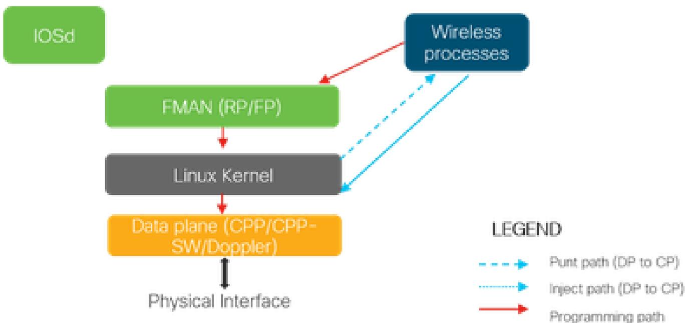
物理ポートから9800 WLCに入るパケットは、制御トラフィックと判断されると、対応するコントロールプレーンプロセスにパントされます。
