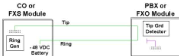
この図では、PBX または FXO でリング回線が接地され、CO または FXS に対して着信コールがあることを示しています。CO または FXS では、リング回線の接地を検出し、チップ回線を接地して PBX または FXO に着信コールを受信する準備ができたことを通知します。応答として、
