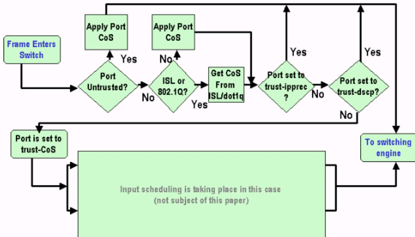
注：上のフローチャートに示すように、各フレームには内部CoS（受信したCoSまたはデフォルトポートCoS）が割り当てられます。これには、実際のCoSを伝送しないタグなしフレームも含まれます。この内部 CoS と受信した DSCP が（データバスヘッダーと呼ばれる）特別なパケットヘッダーに書き込まれ、データバスを通過してスイッチングエンジンに送信されます。これは入力ラインカードで発生し、この時点ではまだ、この内部CoSが出力ASICに伝送され、発信フレームに挿入されるかどうかは不明です。これらはすべて、PFCの動作によって異なり、次の項で詳しく説明します。
