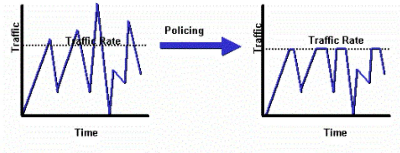
次に、特定のユーザの発信方向の帯域幅を 1 Mbps に調整する例を示します。
