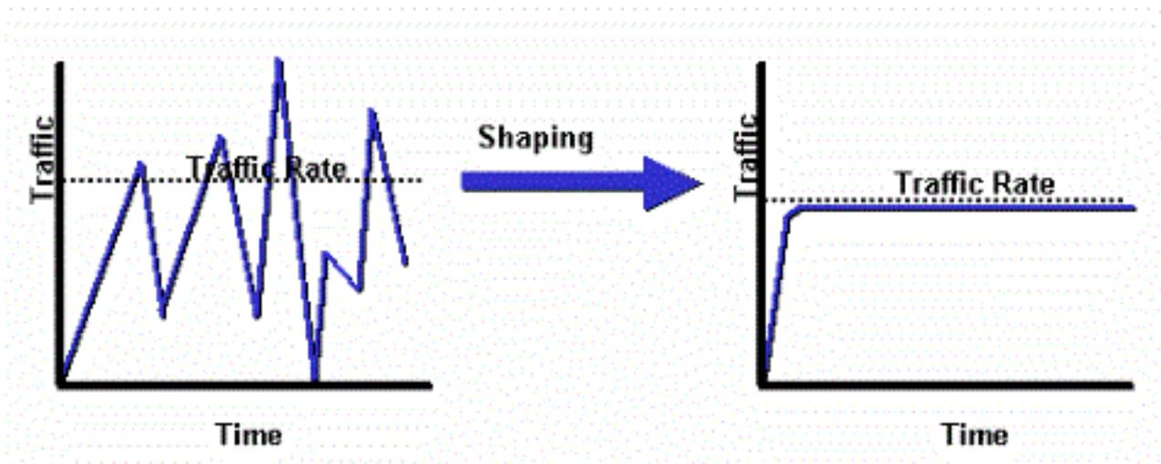
注：トラフィックシェーピングは、ASA バージョン 5505、5510、5520、5540、および 5550 上でのみサポートされます。マルチコア モデル ( 5500-X など ) はシェーピングをサポートしません。
