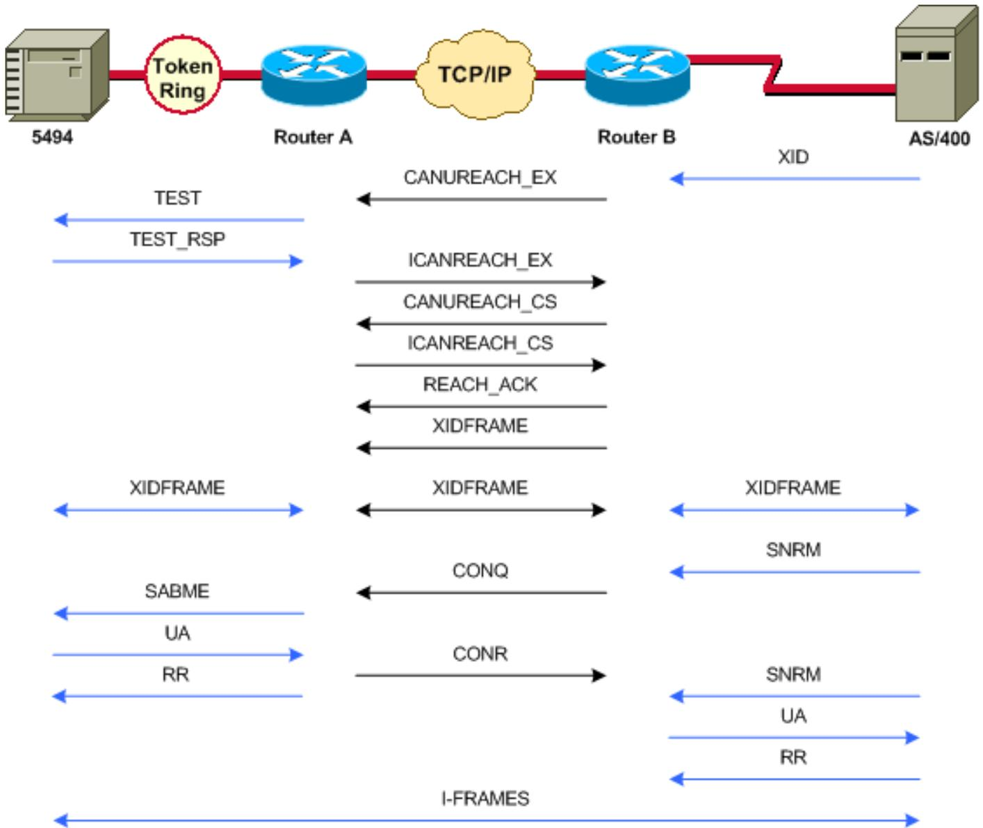
もう一つの一般的なセットアップは逆同期データリンク制御 (SDLC) 論理リンク制御 (LLC;SDLLC) と呼ばれます。これは、プライマリステーションが SDLC 回線経由でルータに接続している場合です。これは通常、ホストをトークンリング接続に移行するホスト環境で見られるものです。このセットアップでは、DLSw が SDLC 回線を取り扱う方法が変わります。このような場合、一般にリモート PU がアクティブであるかどうか非常に不確定だからです。
