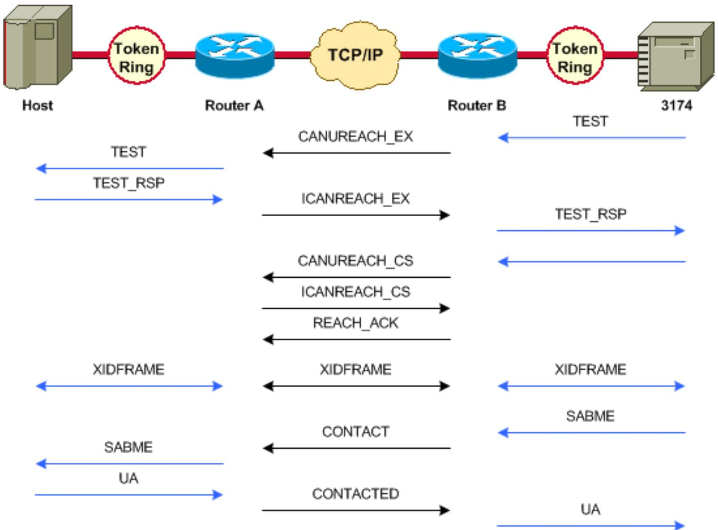
次に、debug dlsw コマンドの例を示します。セッションが正常に起動される場合のフローです。
