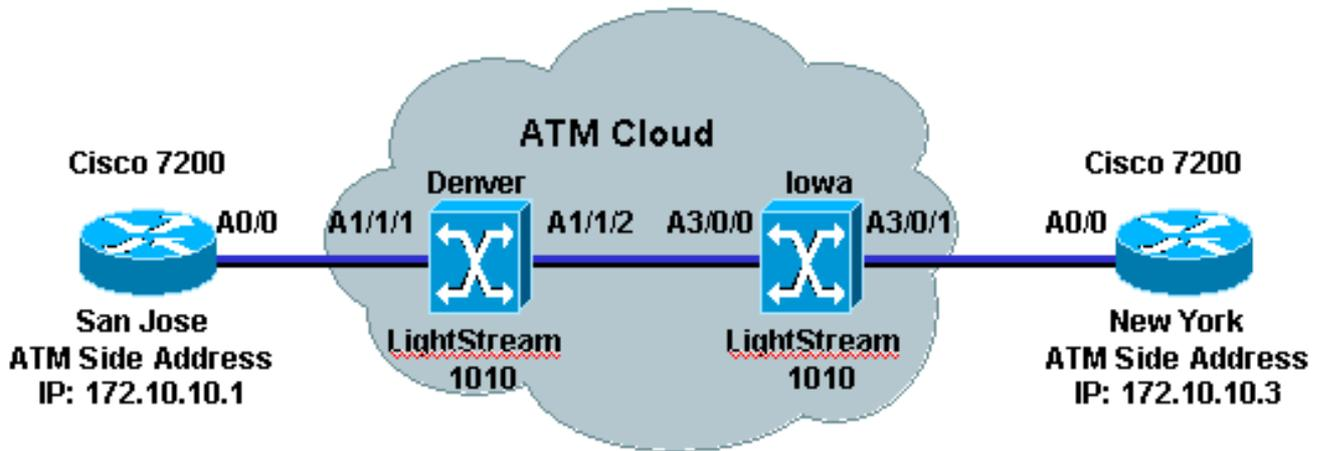
ATM サービスプロバイダーは、両方のエンド デバイスが PVCを設定するために使用する VPI/VCI 情報を提供する必要があります。VPI と VCI のペアは、同じである必要はありません。ATM サービスプロバイダーは VPI/VCI ペア間のスイッチで相互接続を設定します。
