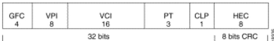
ほとんどのプラットフォームでは、VPIに8ビットを使用します。VPIには0 ~ 255の範囲を指定し、VCIには0 ~ 65535の範囲を指定します。[Cisco ATMルータインターフェイスでのアクティブな仮想回線の最大数についてはプラットフォームごとに異なりますIMA VPI/VCIの範囲の詳細については、『IMAカードの仮想パス識別子/仮想チャンネル識別子\(VPI/VCI\)の範囲はどのようになっていますか。』を参照してください。](#)
