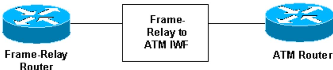
FRF.8 実装協定の Section 5 では、上位層プロトコル カプセル化について 2 つのモードを規定しています。このカプセル化ではヘッダーが参照されます。ヘッダーには、Protocol Data Unit ( PDU; プロトコル データ ユニット ) で搬送されるプロトコルを特定する情報が含まれているため、受信側は着信パケットを正しく処理できます。FRF.8 では、変換モードと透過モードという 2 つのモードが定義されています。インターワーキング機能でどちらのモードを選択するかによって、ATM エンドポイントに設定するカプセル化方式が決まります。
