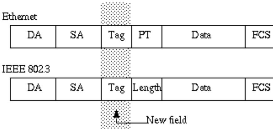
802.1Qトランクでは、ある1つのVLANに、タグを付けない場合もあります。このタグなしのVLANは、デフォルトVLANと呼ばれます。このようにして、タグのないフレームを受信したときに、そのフレームが属するVLANを推測できます。タギングメカニズムは、フレームが修正されることを意味しています。トランッキングデバイスでは、4バイトのタグを挿入し、Frame Check Sequence (FCS; フレームチェックシーケンス)を再計算します。タギング方式の詳細については、『[IEEE 802.1Q VLAN 間のブリッジ](#)』を参照してください。
