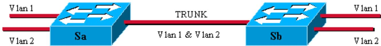
このダイアグラムにある、2つのスイッチ間の唯一の物理リンクでは、どのVLANのトラフィックも伝送できます。これを実現するため、リンクで送信される各フレームにはSaによってタグが付けられ、それにより、Sbはフレームが属するVLANを認識できます。802.1Qでは、内部的なタギング機構を使用しています。内部とは、次に示すように、タグがフレーム内に挿入されることを意味します。
