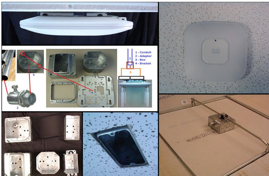
図 34. AP を電気コンジットボックス（天井の T バーまたはコンジット）に取り付ける
