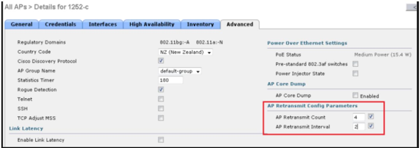
Opzione per modificare il parametro di configurazione della ritrasmissione AP in un punto di accesso specifico
