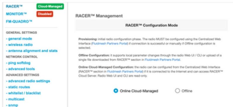
Une fois la radio en mode hors connexion, elle est accessible via l'adresse IP par défaut 192.168.0.10/24. Assurez-vous donc que l'ordinateur portable se trouve sur le sous-réseau approprié pour accéder à la radio.
