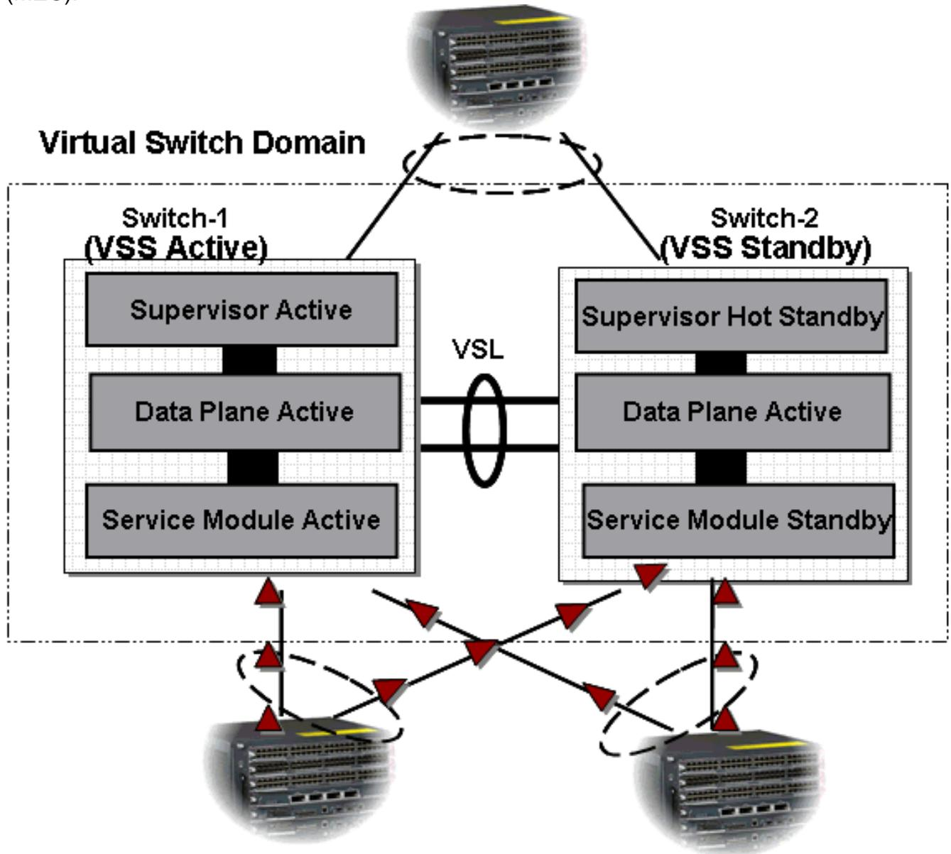
2. Le trafic entrant du commutateur 2 sera redirigé vers le module de service actif dans le commutateur 1. Par conséquent, le trafic devant activer le module de service actif doit traverser la liaison VSL. Il est recommandé que la taille de la liaison VSL soit basée sur la largeur de bande prévue.
