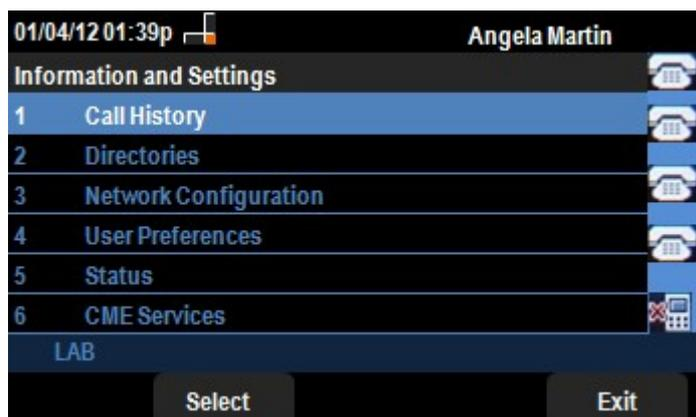
Étape 2. Utilisez les touches de navigation et faites défiler jusqu'à Configuration du réseau. Appuyez sur la touche de fonction **Select**. Le menu *Configuration du réseau* apparaît. À l'aide des touches de navigation, faites défiler jusqu'à l'option VLAN.
