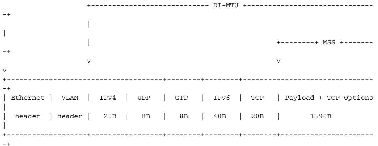
Si la MTU de túnel de datos configurada es inferior a 1490 en el caso anterior, la política de excedentes mtu se aplicará al paquete.
