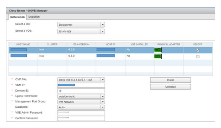
Confirme que está agregando los adaptadores físicos al DVS de Vmware y no al DVS Nexus 1000VE.
