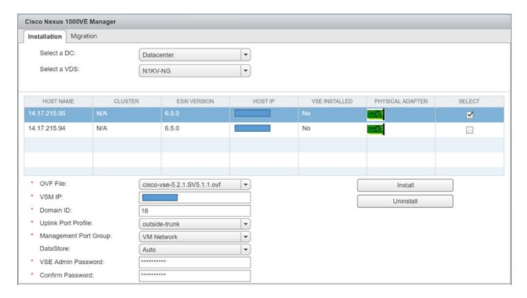
Seleccione la casilla de verificación de un host de la lista de hosts y haga clic en el icono del adaptador físico para abrir el cuadro de diálogo Seleccionar PNICS para VDS externos.
