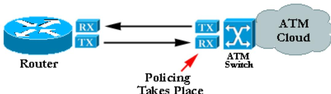
**Nota:** Estos diagramas no implican que el modelado y la regulación del tráfico se refieran a un contrato común y utilicen un algoritmo similar. La regulación o el modelado mal configurados a menudo conduce a celdas que son descartadas por el regulador. Incluso si el modelado y la regulación de tráfico se establecen en los mismos valores, la regulación de tráfico puede comenzar a descartar celdas. Esto suele deberse a un modelador deficiente o a un regulador que funciona mal.
