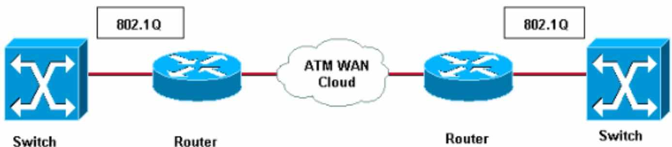
No obstante, existe una manera alternativa para crear VLAN de extremo a extremo. Configure ambos routers con el mismo grupo de puentes y subinterfaces 802.1Q. En otras palabras, los dos extremos del router poseen un mapeo uno a uno entre un grupo puente y una subinterfaz 802.1Q.
