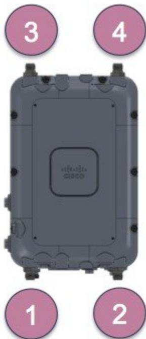
AP1572EC には、アクセス ポイント (AP) 上部に 2 つと AP 底部に 2 つの計 4 つの N タイプ コネクタ付きアンテナポートがあります。デュアルバンドモードでは、2.4 GHz と 5 GHz の両方の 3 つの空間ストリームを使用した 4 つのトランスミッタと 4 つのレシーバを構成する (4x4:3) ためにすべてのアンテナポートが使用されます。複数のバンドをサポートするアンテナは、二重放射素子 (DRE) と呼ばれており、アンテナ内部に二重放射素子が組み込まれています。
