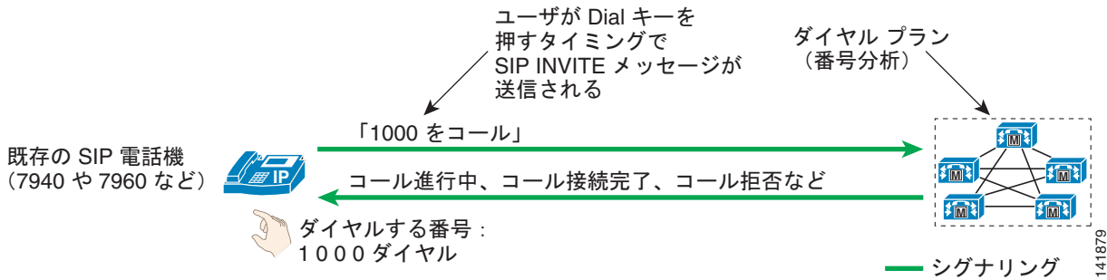
図 9-24 ダイアル規則が設定されていないタイプ A の SIP 電話機でのユーザ入力とフィードバック
