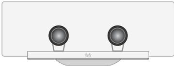
Cisco TelePresence SpeakerTrack 60 は、2 台の Cisco TelePresence Precision 60 カメラと拡張スピーカー トラッキング用マイク パネルを基本とします。
