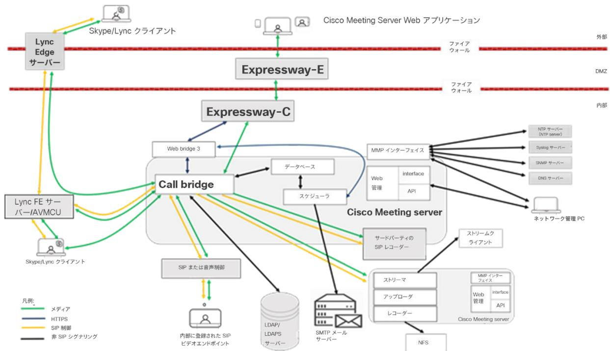
リモートワークの需要が高まり、Web アプリの規模を拡大する必要性が高まっていることから、この Web アプリの規模拡大のためのエッジサポートを提供するため、Cisco Meeting Server バージョン 3.1 が開発およびテストされています。図 9 は、Meeting Server Web エッジソリューションを導入して、Web アプリの規模を拡大するために展開を最適化する方法の例を示しています。
