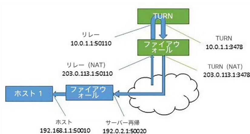
このリレー候補は 2 回使用されています。ホストはパケットを遠端に送信するためにも使用できます。これは、他にパスがない場合に発生します。これらのパケットは TURN サーバーそのものから送信される形式であるため、ファイアウォールで書き換えた場合にのみ NAT アドレスが取得されますので注意してください。
