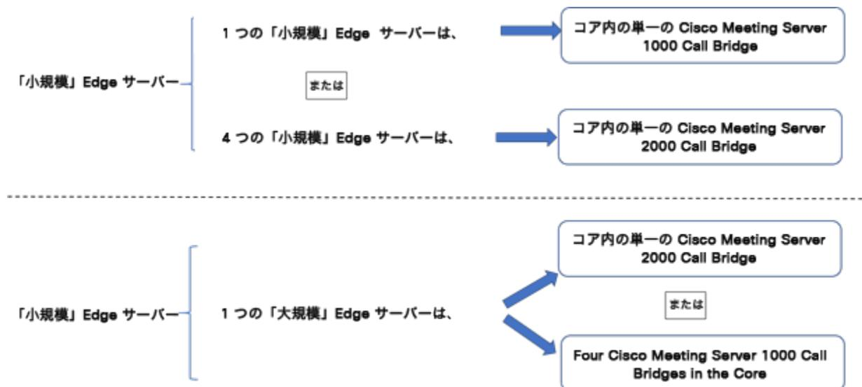
コア Call Bridge がサポートする Call Bridge コールキャパシティ、および使用されている Edge サーバーのハードウェア構成を確認して、必要な Edge サーバーの数を決定します。
