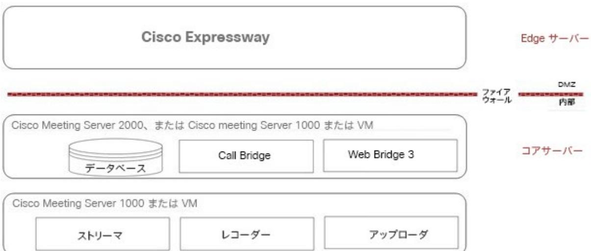
エッジサーバーとして使用する場合、Meeting Server は、図 3 に示すように、既存の TURN サーバーおよび Web アプリコンポーネント（Call Bridge コンポーネントではない）を使用します。
