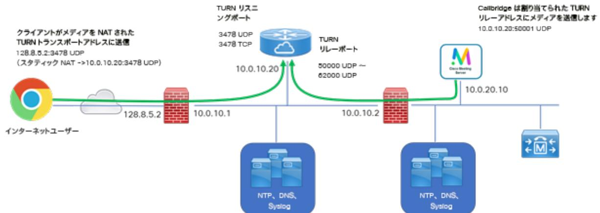
**注意：** Edge Meeting Server は DMZ 内にある必要があります。信頼レベルやセキュリティエンクレープが異なるネットワークに直接接続しないでください。TURN サーバーがリレーの役割を実行するために必要なインターフェイスは 1 つだけです。Meeting Server は複数のインターフェイスをサポートしていますが、異なるレベルの信頼できるネットワーク (DMZ とイントラネットなど) に同時に直接接続しないでください。この製品はハードウェアまたはプロセスの分離を提供せず、1 つのエンクレープから別のエンクレープへと移動しようとする攻撃に対する保護を提供しません。
