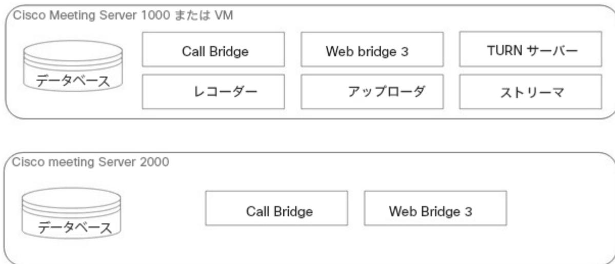
図 2 と図 3 は、分割型サーバー展開で使用可能なコンポーネントを示しています。図 2 は、Cisco Expressway によって提供される TURN サービスを示し、図 3 は Meeting Server の TURN サーバーコンポーネントを使用して Meeting Server が提供する TURN サービスを示しています。Meeting Server の TURN サーバーコンポーネントが有効になっている場合、Web Bridge 3 は Edge サーバーに移動します。レコーダー、アップローダ、およびストリーマのコンポーネントは、会議をホストする別のコアサーバー上で有効にする必要があります。
