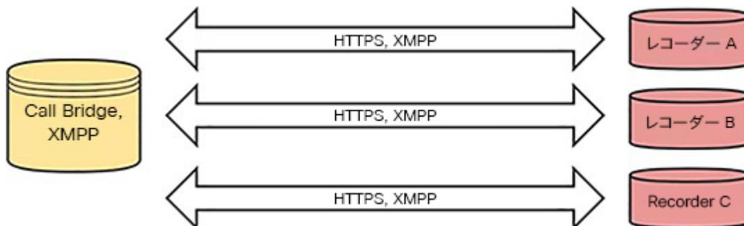
新しい内部 SIP レコーダーコンポーネントの場合、コール制御はコール制御プロバイダを経由します。その間、ほとんどの場合、メディアは Call Bridge とレコーダーの間を直接流れます。コール制御プロバイダの設定によっては、メディアがコール制御プロバイダを経由することもあります。図 43 に、この新しいレコーダーのコール制御フローを示します。
