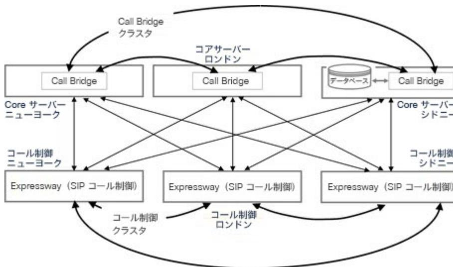
例 2：地理的に分散されたコール制御システムがある場合、これらの VCS をローカルの Call Bridge に選択的にトランキングできます。たとえば、ロンドンの VCS はロンドンベースの Call Bridge にトランキングでき、ニューヨークベースの VCS はニューヨークベースの Call Bridge にトランキングできます。これにより、メディアがデータセンター間で不必要に移動することがなくなり、複数の場所にまたがる会議では、データセンター間の帯域幅の使用を最小限に抑えるために、Call Bridge 間に単一のピアリンクが存在します。
